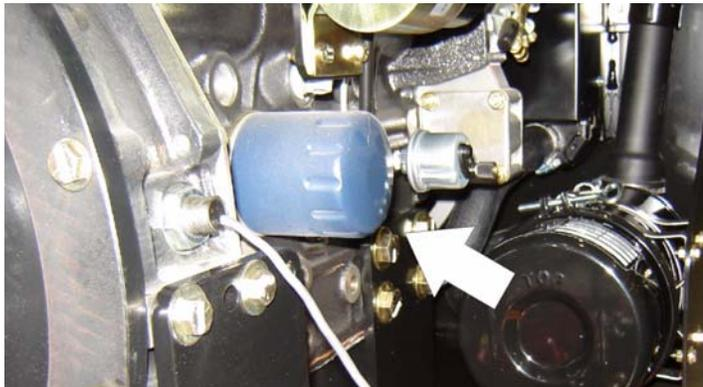
Punto(s) de lubricación - Tapa de llenado/elemento atornillable (N/P JLG 7026855)
