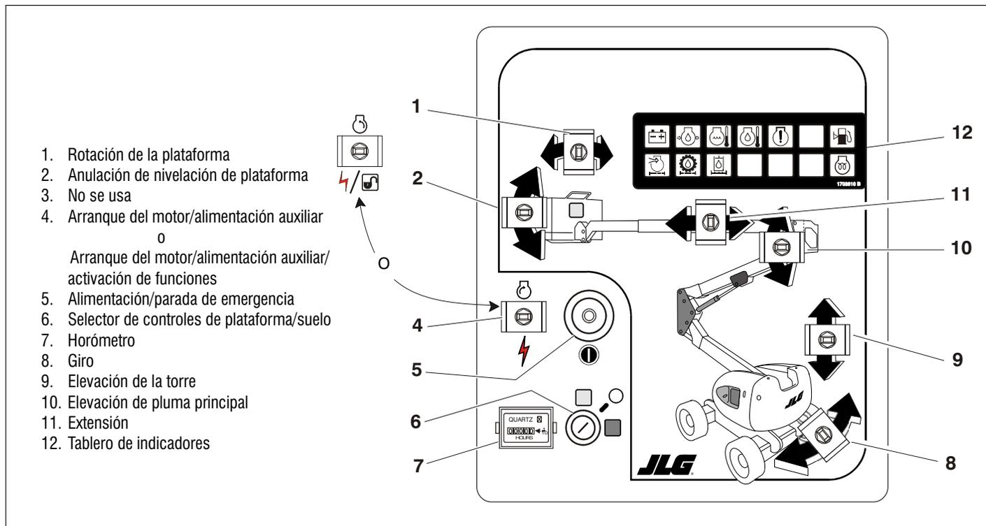
Figura 3-1. Estación de control del suelo - Modelos A
