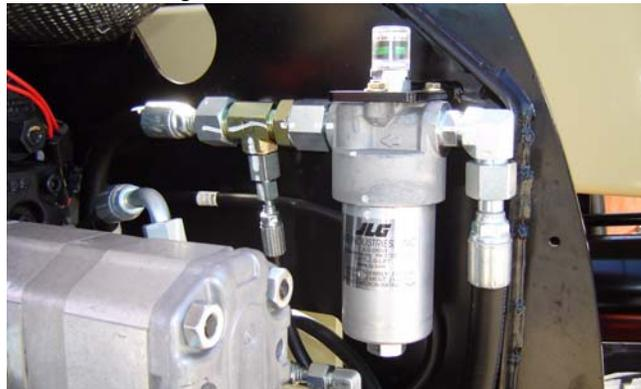
Intervalo - Cambiar después de las primeras 50 horas y cada 6 meses ó 300 horas de allí en adelante, según lo requiera el indicador de condición.
