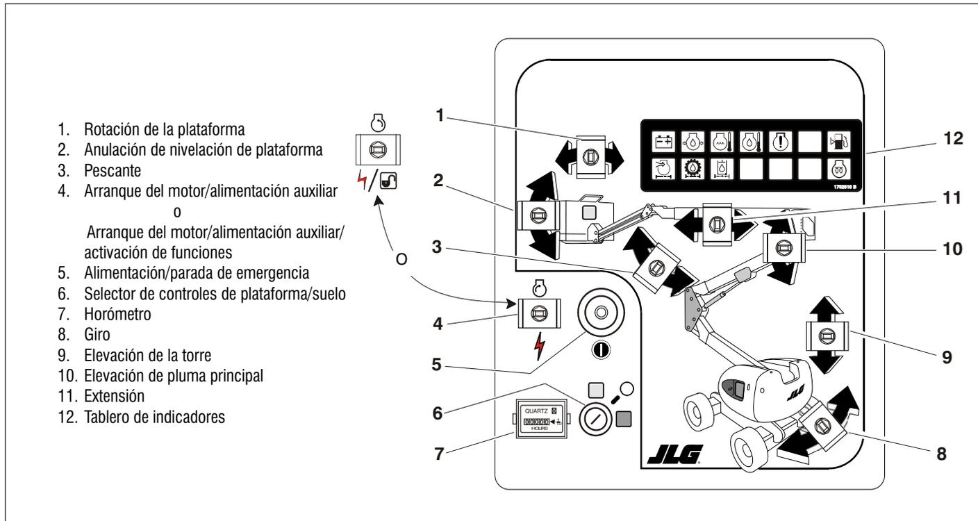
**Figura 3-1. Estación de control del suelo - Modelos AJ**
