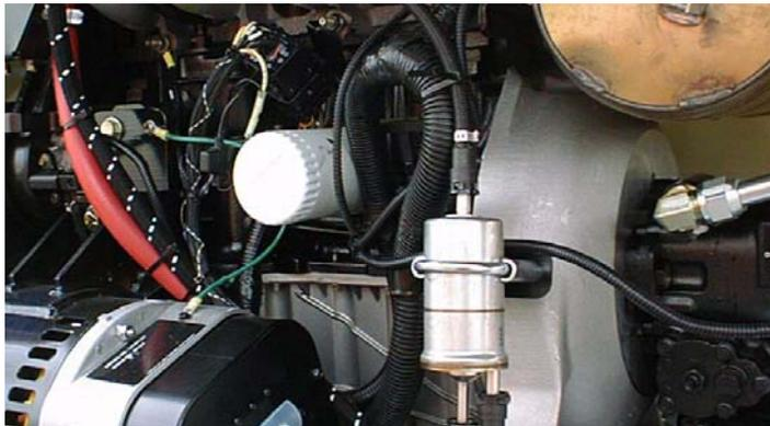
Punto(s) de lubricación - Tapa de llenado/elemento atornillable (N/P JLG 7014501)
