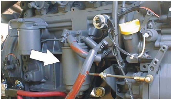
Punto(s) de lubricación - Elemento sustituible
