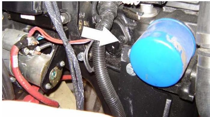
Punto(s) de lubricación - Tapa de llenado/elemento atornillable (N/P JLG 7027965)
