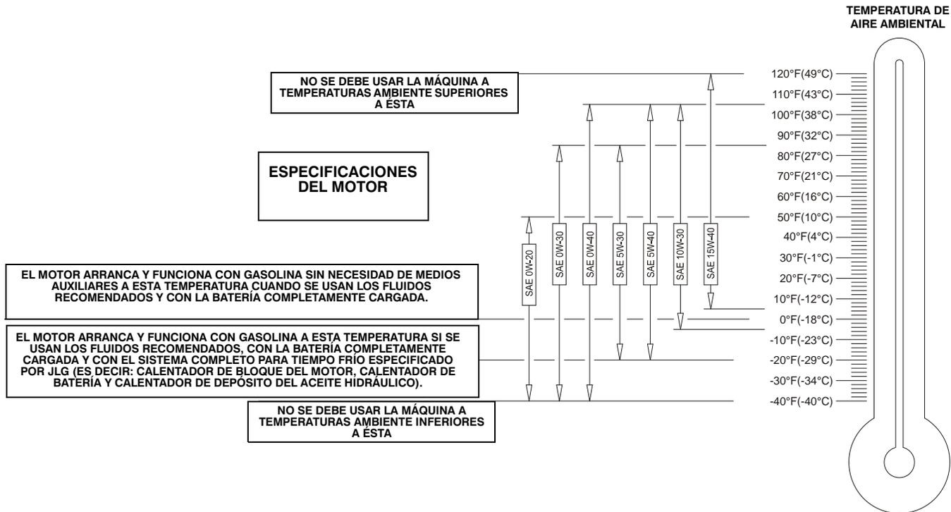
Figura 6-10. Especificaciones de temperaturas de funcionamiento del motor - Perkins - Hoja 1 de 2
