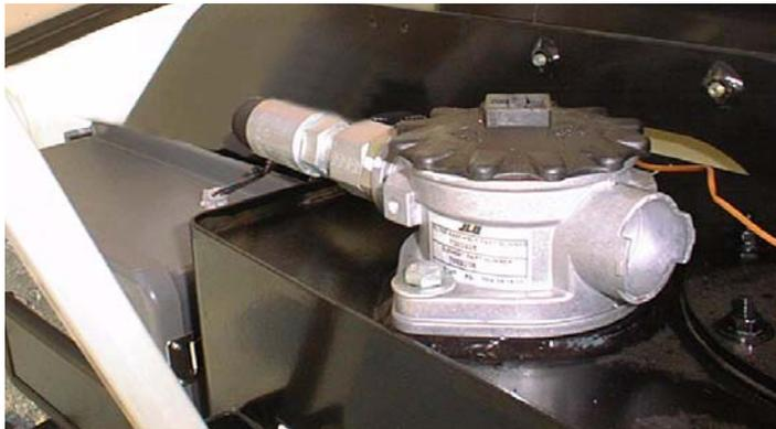
Intervalo - Cambiar después de las primeras 50 horas y cada 6 meses ó 300 horas de allí en adelante, según lo requiera el indicador de condición.
