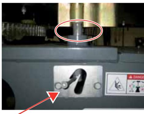
Sujeción de la máquina
