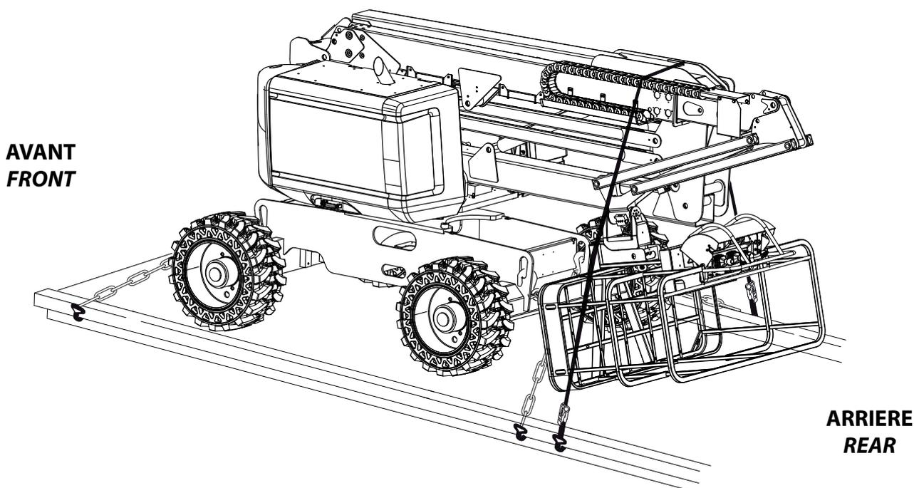
**Nota:** Bloquee la torreta con el pasador de bloqueo antes de un desplazamiento de larga distancia o el transporte de la máquina en un camión.
